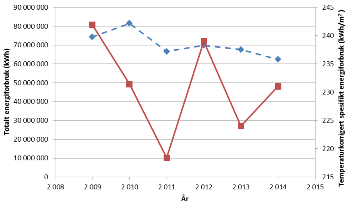
Figur 1: Totalt energiforbruk i kWh (stiplet linje) og temperaturkorrigert spesifikt energiforbruk, kWh/m 2 (heltrukken linje), for Universitetet i Bergen i fra 2009-2014.
