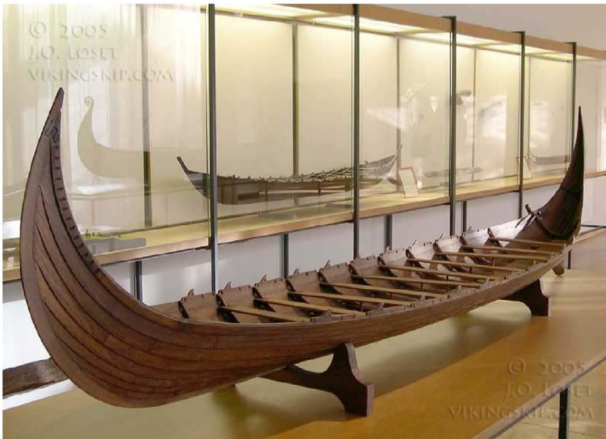
Fig. 21. Rekonstrueret model af Kvalsundskipet fundet ofret i en mose Herøy på Sunnmøre i 1920. Den er dateret til 600 tallet. Båden har ikke haft mast og sejl, men blev drevet af 10 årepar. Den var 18 meter lang og 3,2 meter bred. Foto Bergen Sjøfartsmuseum.
