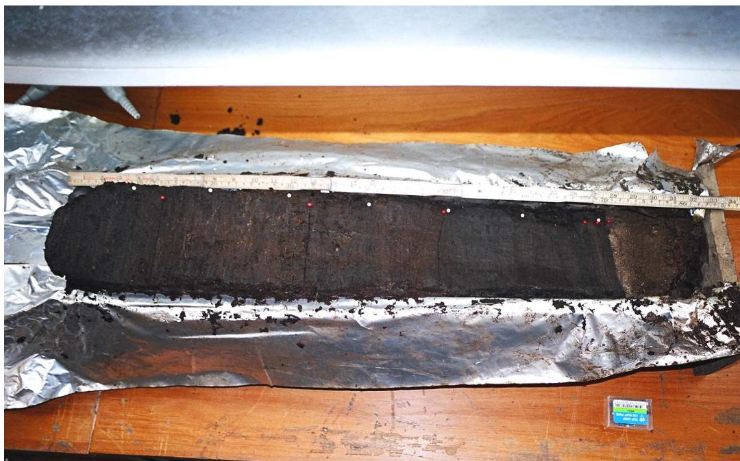
Figur 6. Kasseprøven fra sjakt A. Topp til venstre. Hvite nåler satt hver 10 cm der nullpunkt er satt til toppen av kjernen. Røde nåler viser laginndeling. (Foto: L. S. Halvorsen)
