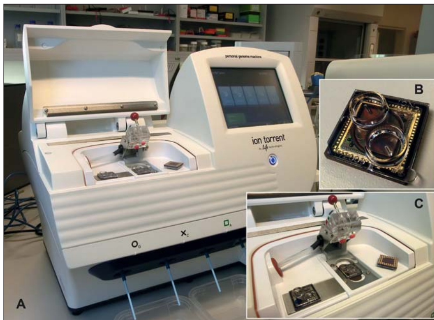
■ Fig. 5. IonTorrent-instrumentering – årets nyanskaffelser på DNA-Lab. A, Ion Personal Genome Machine (Ion PGM); B, Ion chip (halvlederbrikke). C, Chip clamp, feste for halvlederbrikke. Her skjer sekvenseringen (se faktaboks 4). Foto: Beate Helle.
