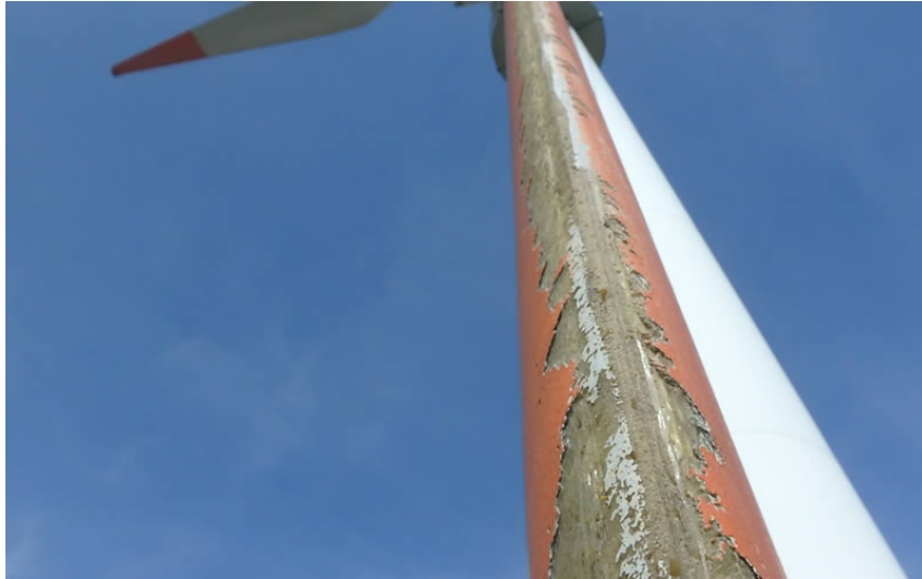
Figur 6: Rotoblad forkant etter lang tids operasjon i regn [Kilde: Armour EDGE].
