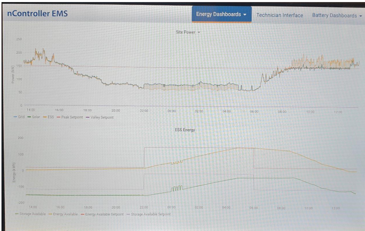
Figur 4 – Skjermbilder fra batterianleggets kontrollpanel. Over: Oversiktsbilde med status. Under: Logget energiflyt siste 24 timer. Her fremvises settpunkt for når batteriene skal bidra med effekt, samt effekt fra nettet, fra batteriene, til byggets forbruk og fra solcellene. Produksjon fra solceller var null denne dagen.
